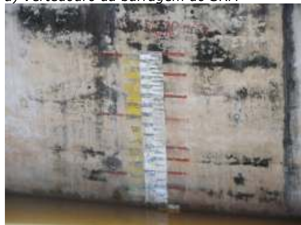
c) Detalhe do medidor de nível no vertedouro
