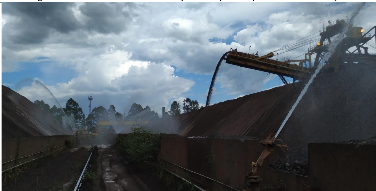
Figura 36: Funcionamento do sistema de aspersão em pilhas de produto da CSN Mineração.
